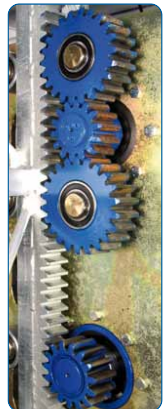
Piñones de grupo motriz y paracaídas Drive unit and overspeed brake pinions
